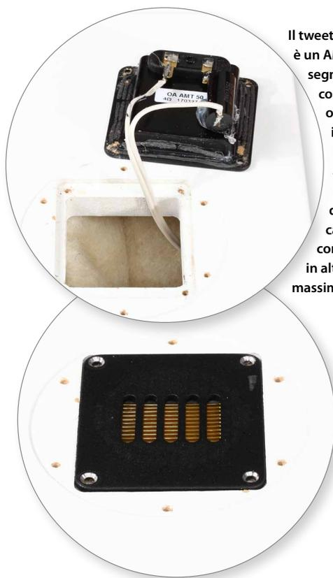
Il tweeter installato in cima ai diffusori è un AMT 50 collegato in parallelo al segnale del tweeter anteriore ma con un filtro passivo a 6 dB/oct ottenuto con un condensatore i poliestere da 2.2 uF in serie. La risposta si allinea intorno ai 20 kHz con quella anteriore ma già a 10 kHz è attenuata di 6 dB. Il contributo nel campo riflesso quindi si deve considerare prevalentemente in altissima frequenza con un massimo a circa 15 kHz.
