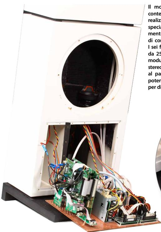
Il modulo per la gestione dei contenuti a bordo e in rete è realizzato dalla Audiovo, ditta specializzata per Streamer HD, mentre gran parte della sezione di controllo è realizzata ad hoc. I sei finali di potenza in classe D da 250W della Pascal Audio, un modulo stereo con due estensioni stereo della serie S-Pro, sono fissati al pannello con i dispositivi di potenza a contatto con il rame per dissipare il calore.
